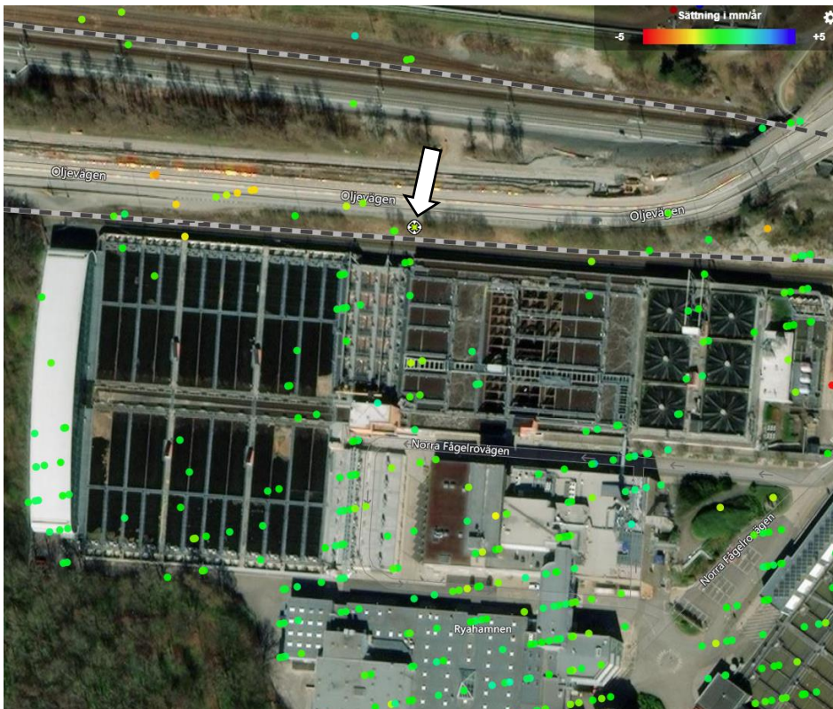
Figur 7. Överblick över punkter med sättningsrörelser (Sättningskartan.se). Vald punkt som redovisas i Figur 8 är markerad med vit pil.
