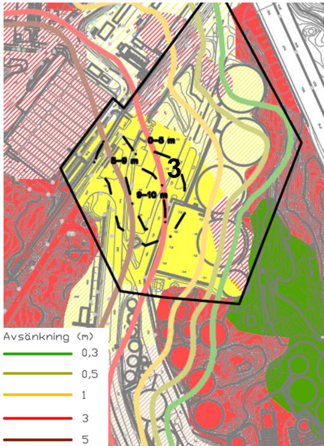
Figur 20. Grundvattenavsänkning inom delområde 3. Avsnäkningskurvor för grundvattenavsänkning visas i olika nyanser av orange-grön, vilket representerar en avsänkning på 3–0,3 meter. I området med lera (markerat med gult område) visas även avsnäkningskurvorna mot en tolkning av mäktigheten på leran som redovisas med svartstreckad linje.
