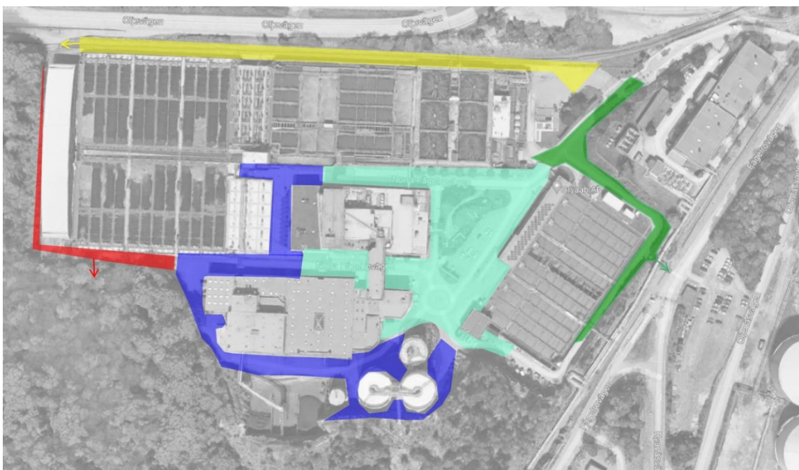
Figur 5-5. Dagvattensystemets fem avrinningsområden.
