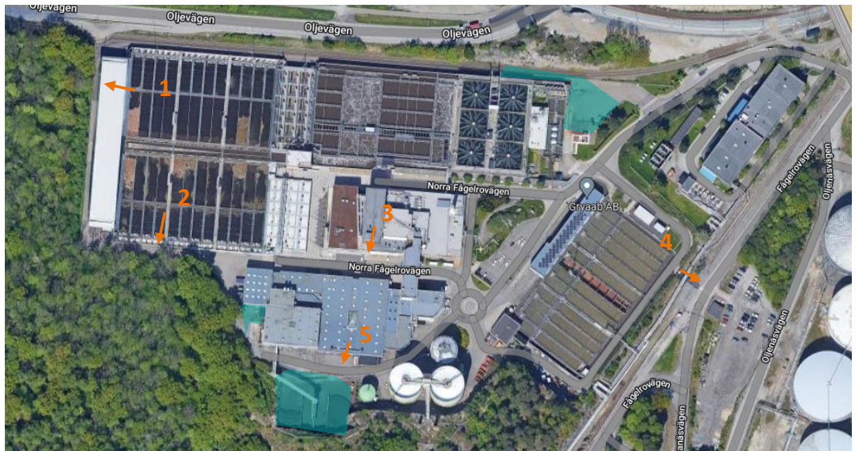
Figur 7. Visar vart dagvattnet mynnar ut i på Gryaab anläggning samt avrinningsområden där vattnet når spillvattenledningarna.
